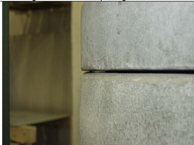
Abbildung: Restspalt bei 479 kN
